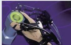
CyberGrasp は手の「触覚」を追求した究極のインターフェイスです。各指先に取り付けたワイヤーを制御してリアルなフォースフィードバックを実現し、実際に触れているかのような感覚を体験することができます。硬いものはもちろん、やわらかいものや押し出してくるようなもの、現実には難しい材質の感覚さえも表現することができます。位置・角度センサ CyberGlove との組み合わせで仮想空間に完全な自分の「手」を再現できます。
