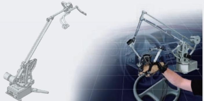
手の動きを3次元の位置と角度変化としてとらえ、リアルな力を手や腕に伝えることができる、世界初の手全体を網羅したフォースフィードバックデバイスです。手指角度3次元位置をリアルタイム3次元CG画像として出力することにより、仮想的なオブジェクトの操作を視覚的に体感することを可能にします。
