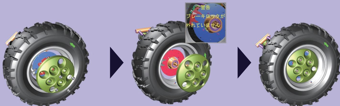
3D CADのデータを直接読み込み、アニメーション機能を利用して組立分解の手順を簡単に作成するツールです。2次元図面では伝わらない構造・機能・手順を容易に理解することが出来る手順書として利用できます。
